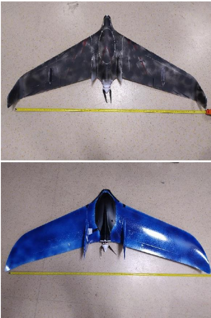
Abb. 2.9: Verwendete Drohnen zur Positionsgenauigkeitsbestimmung, Spannweite von 1,5 m und 2 m (Foto: PNE 2023).
